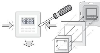
6.1. Снимите крышку терморегулятора, для чего с помощью тонкого плоского предмета отожмите защелки через прорези на боковой поверхности корпуса. Затем снимите декоративную рамку.
